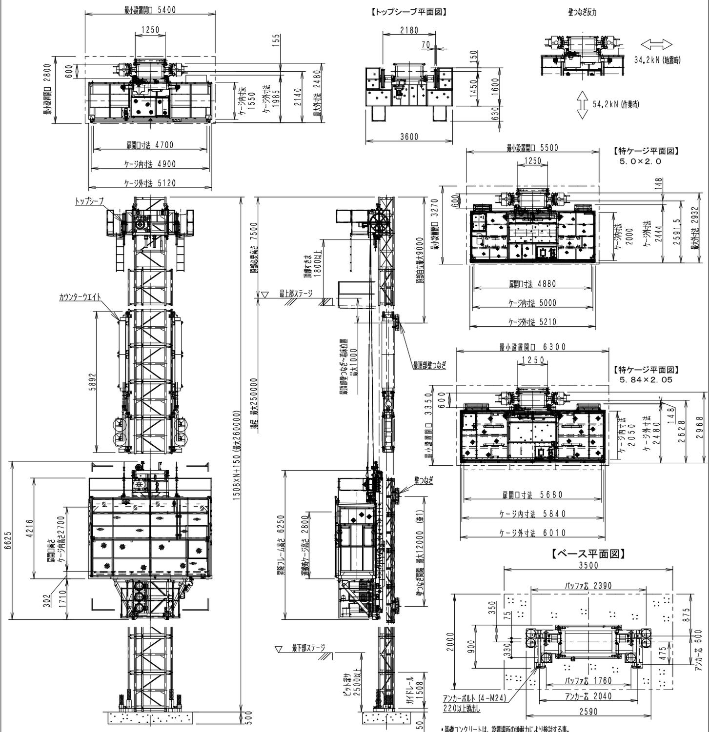
\*基礎コンクリートは、設置場所の地耐力により検討する事。
