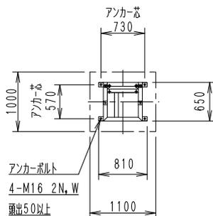
・基礎コンクリートは、設置場所の地耐力により検討する事。
