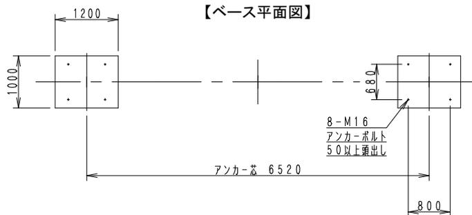
・基礎コンクリートは、設置場所の地耐力により検討する事。
