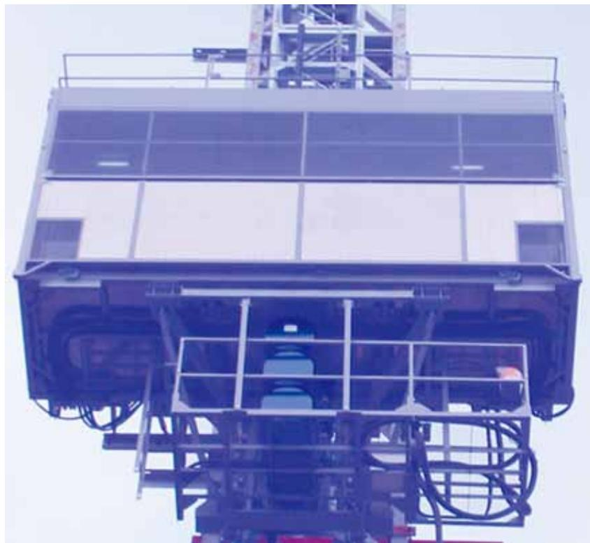
アルミパネル軽量型大型ケージ+高出力、高効率電動機
