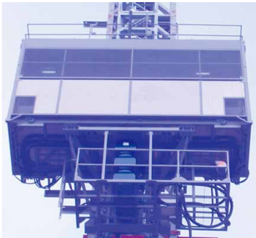
アルミパネル軽量型大型ケージ+高出力、高効率電動機
