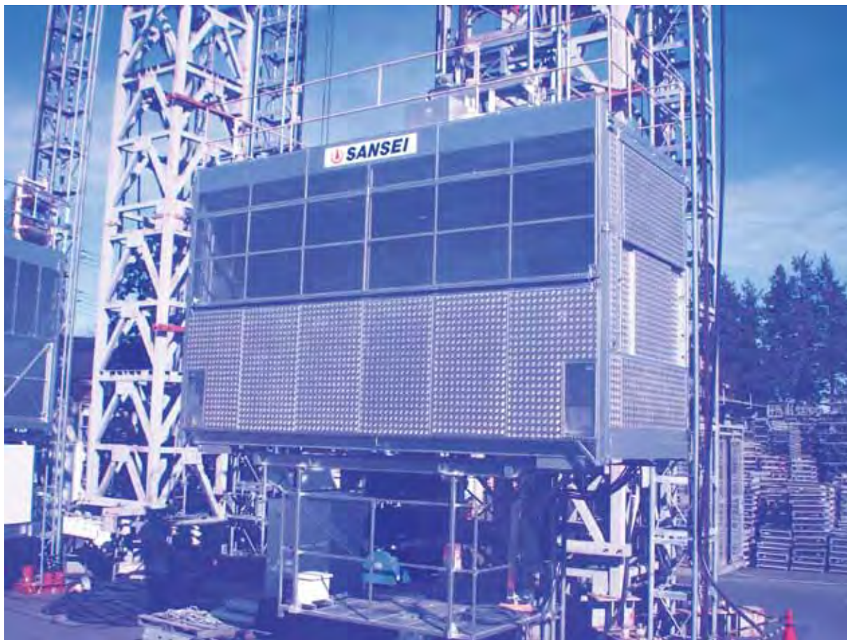
アルミパネル軽量型大型ケージ+高出力、高効率電動機
